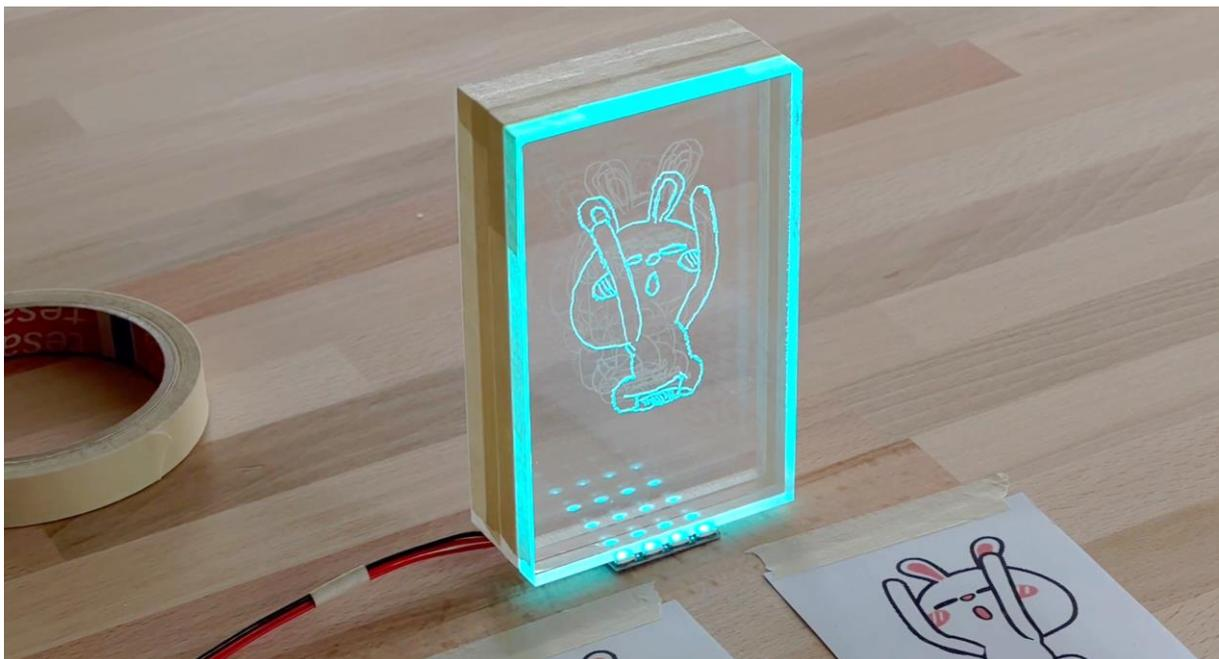
Abbildung 7: Neopixel Matrix mit 4x4 Pixeln unter den Bildern
