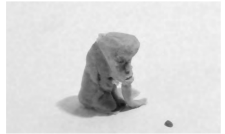
Für die Abformung wird ein Plastikbecher am Boden aufgeschnitten, abgedichtet und mit Silikon gefüllt. Aus der aufgeschnittenen Negativ-Form entsteht in einem neuen Becher die Silikon-Form mit Einguss und Entlüftung. Am Gussrohling sind die Gusskanäle noch sichtbar.
