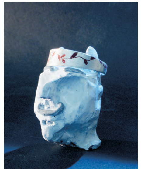
Für die Abformung wird ein Plastikbecher am Boden aufgeschnitten, abgedichtet und mit Silikon gefüllt. Aus der aufgeschnittenen Negativ-Form entsteht in einem neuen Becher die Silikon-Form mit Einguss und Entlüftung. Am Gussrohling sind die Gusskanäle noch sichtbar.
