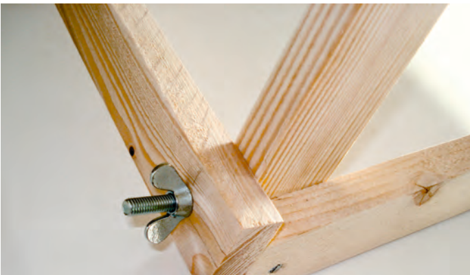
Stabile und demontierbare Schraubverbindung
