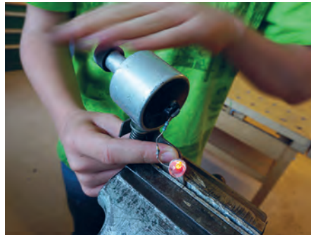
Dynamotest: LED mit Widerstand anschliessen.
