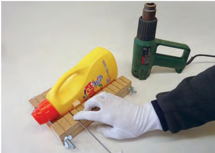
Anzeichenhilfe zum Stechen paralleler Achslager
