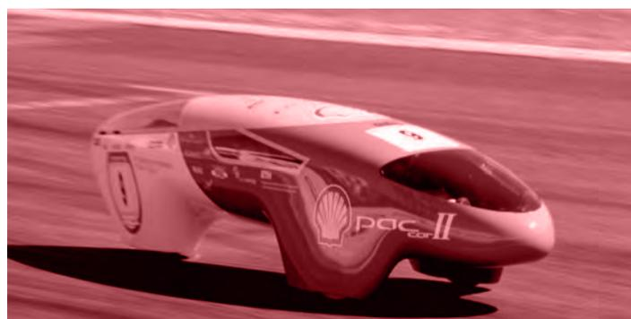
Dank konsequentem Leichtbau und modernster Technologie fuhr der von ETH-Studierenden entwickelte PAC-Car II mit einem Liter Benzin über 5000 km weit. (Quelle: ETH Zürich)
