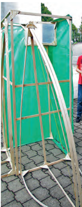
Bei der Realisation im Freien zeigt sich, ob die gewählten Verbindungstechniken und die statischen Annahmen auch wirklich passen.
