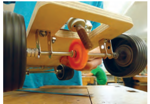
Technische Modelle im Unterricht werden meist mit schnell drehenden Elektromotoren angetrieben, die nur geringe Antriebskraft haben. Der Einbau eines Getriebes verstärkt die Antriebskraft und reduziert die Geschwindigkeit.
