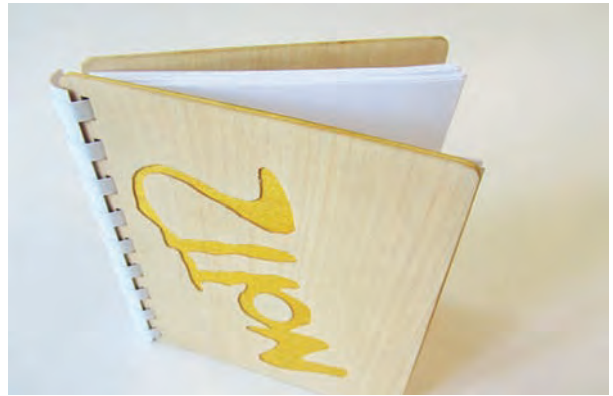
Notizblock – beim obersten Furnierblatt wird ein Schriftzug als Fenster ausgesägt (Furnier zwischen Kartons klemmen und mit Laubsäge aussägen).
